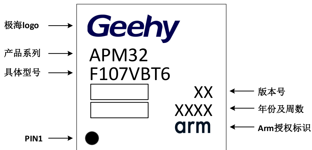
图 16 LQFP100 - 100 引脚, 14 x 14mm 封装标识
